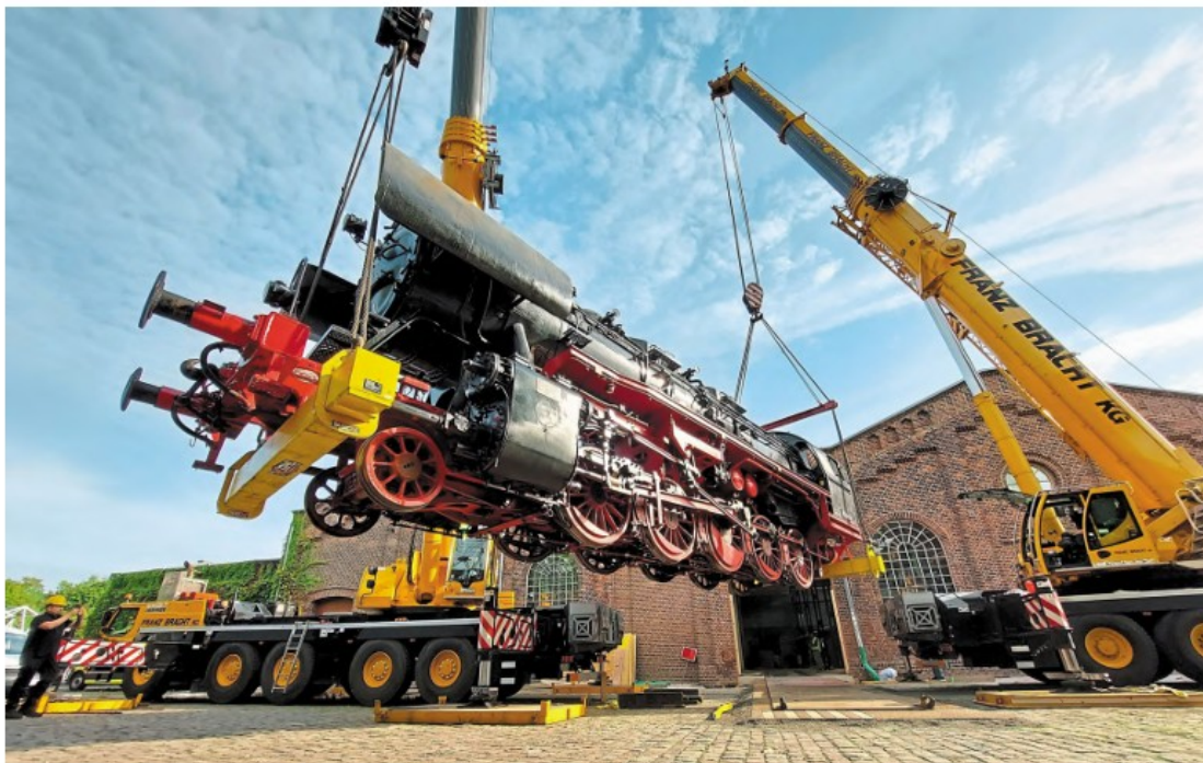
Lastkräne haben den 80 Tonnen schweren Koloss vom Tieflader abgehoben.
